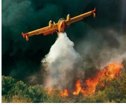
Вода имеет важный вторичный эффект: превращаясь пар, она 1700 расширяется при этом раз. Возникшее большое облако пара окружает пожар, вытесняя воздух, в котором кислород, содержится необходимый для поддержания процесса горения. Таким образом, кроме охлаждающей способности, вода обладает эффектом объемного тушения.
